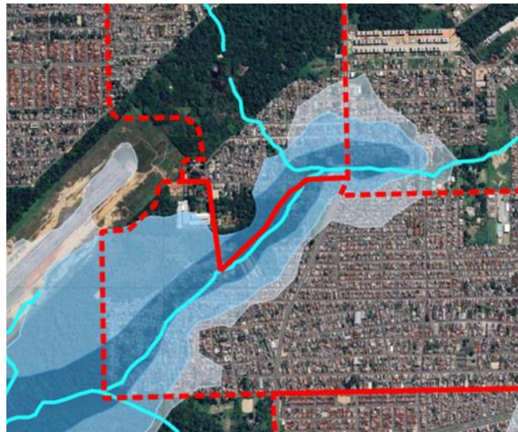
Figura 14 — Mancha de Alagamento no Bairro do Bengui
