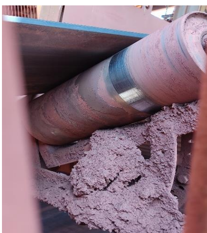
Figura 11 - Acúmulo de minério no rolete de carga em um transportador de correia
