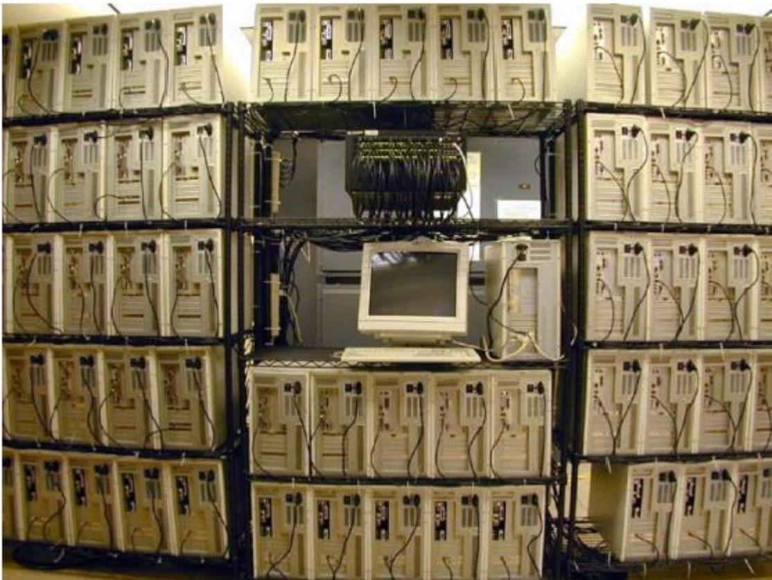
Figura 10: Exemplo de cluster Beowulf de estações de trabalho
