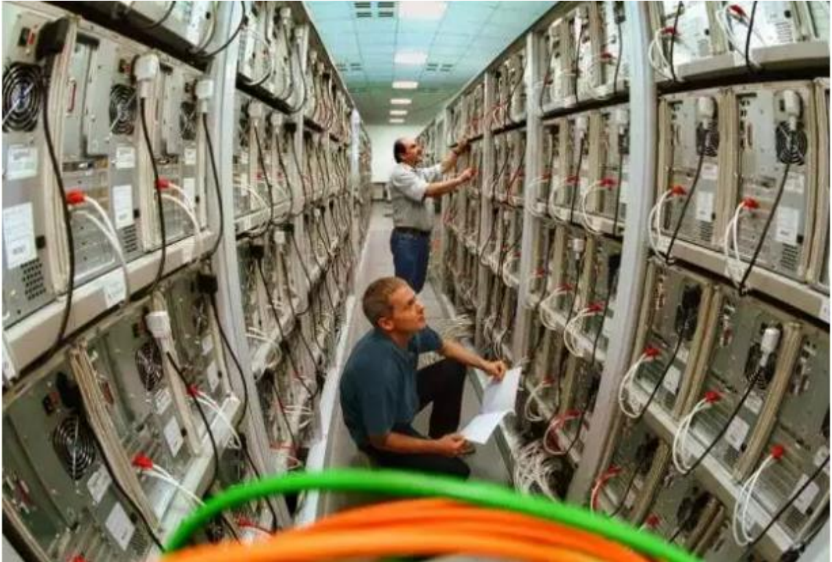
Figura 2: Cluster montado com desktops
