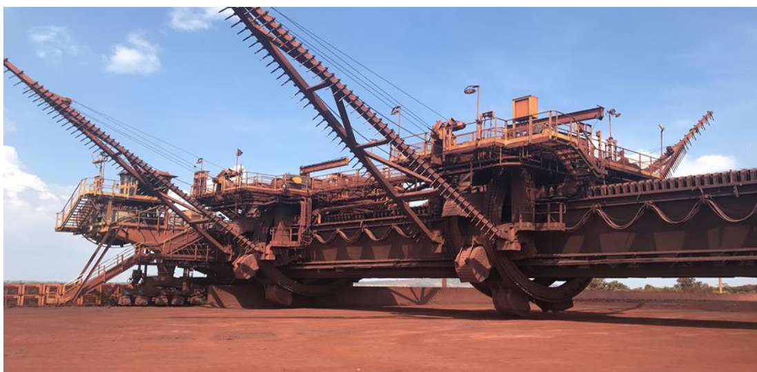
Figura 11. Recuperadora de Minério de roda de caçamba tipo ponte – RC-3011KN-01.
