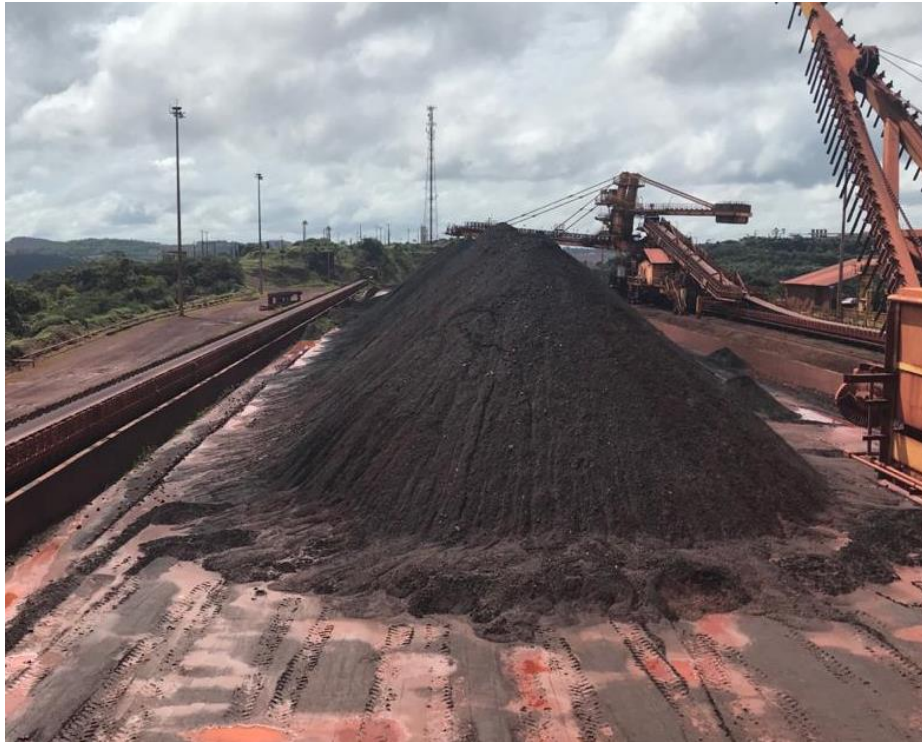
Figura 15. Pilha de minério estocada no pátio de regularização.
