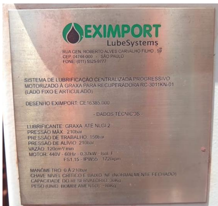
Figura 33. Especificações do Sistema de lubrificação centralizado da Eximport LubeSystems .
