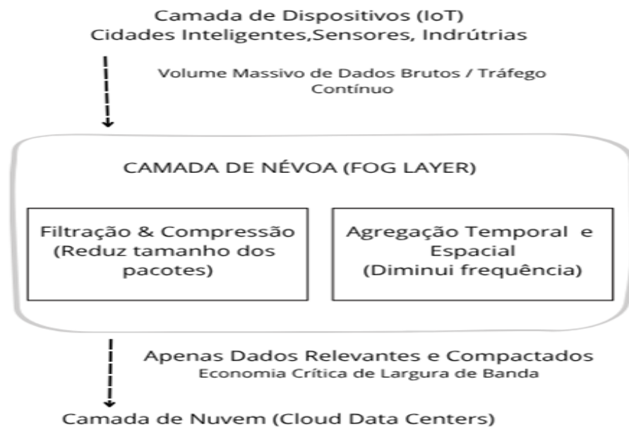
Figura 4- Fluxo de dados e otimização de banda na arquitetura de computação em névoa.
