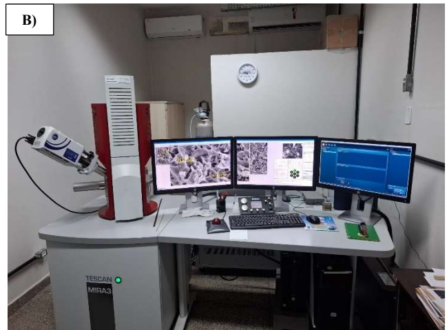
Figura 24 – Caracterização de Fraturas. a) Máquina de Ultrassom. b) Microscópio eletrônico de varredura.
