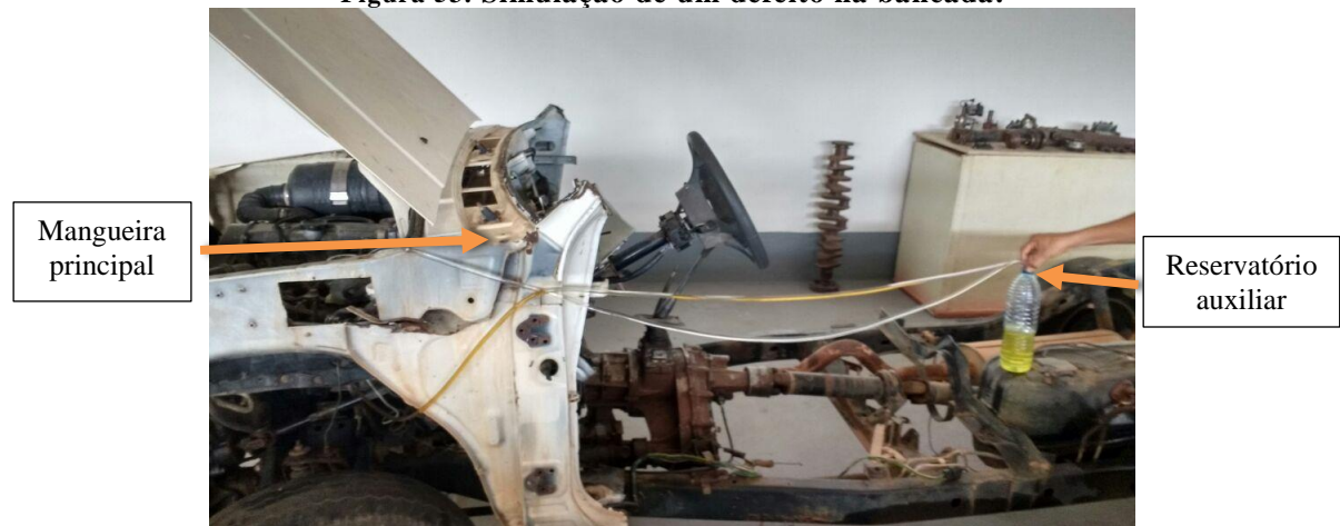
Figura 53. Simulação de um defeito na bancada.
