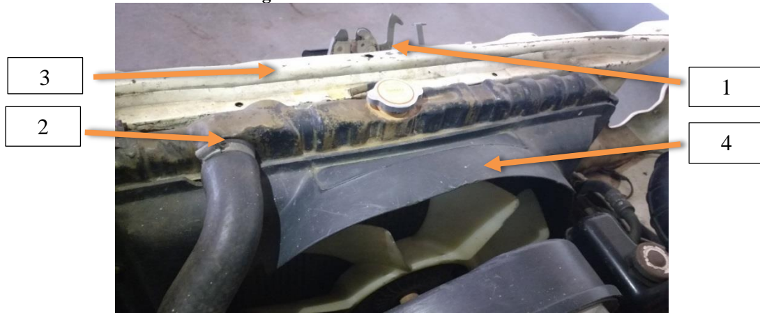
Figura 46. Radiador e ventilador.
