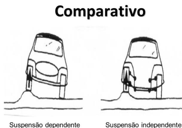
Figura 25. Comparação entre sistema dependente e independente.
