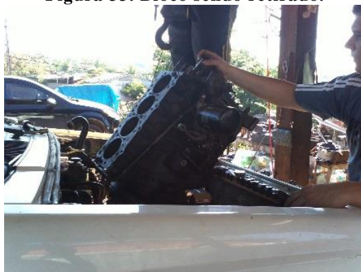
Figura 33. Bloco sendo retirado.
