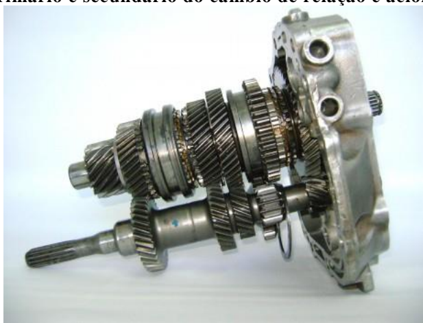
Figura 16. Eixo primário e secundário do câmbio de relação e acionamento mecânico.
