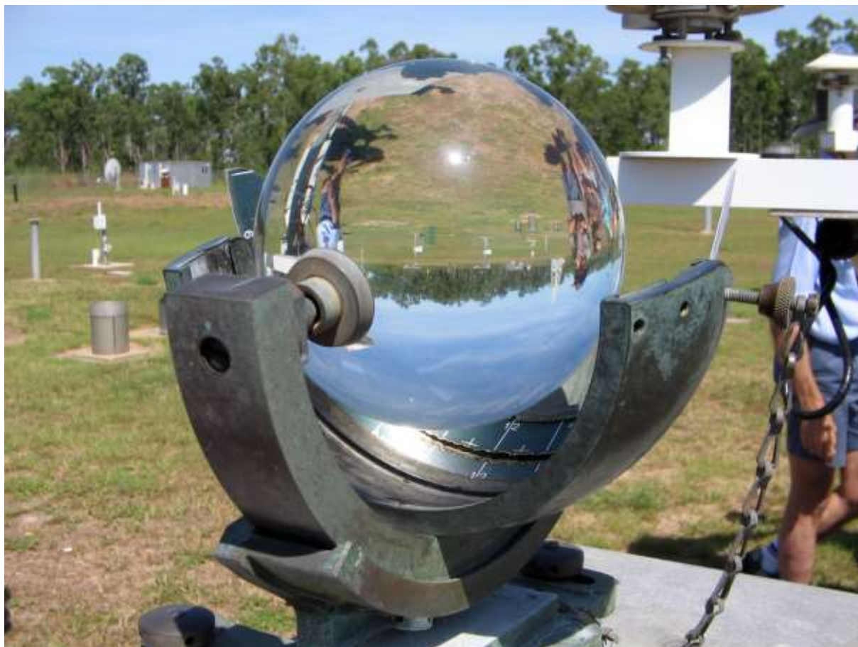
Figura 2 – Aspecto estrutural básico de um heliógrafo de Campbell-Stokes .
