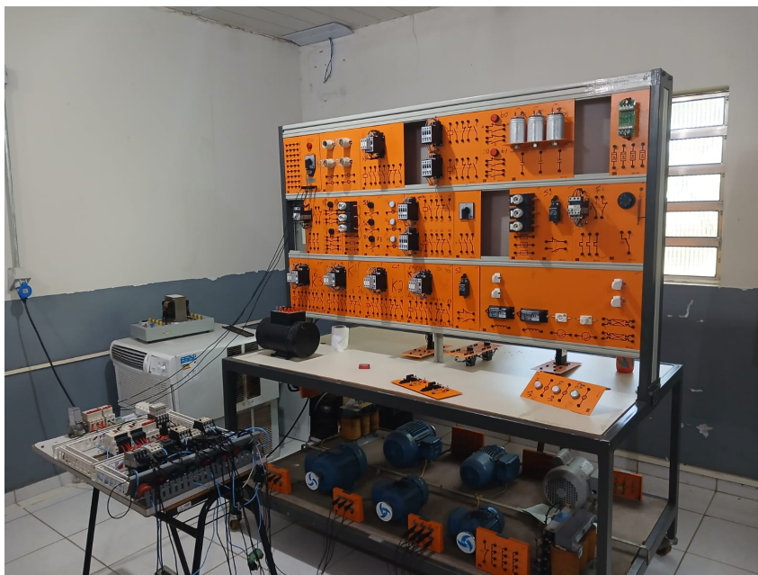
Figura 36 – Estrutura experimental utilizada na validação do sistema de comando da ponte rolante
