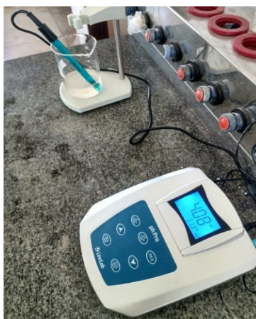
Figura 5. Teste de pH realizado no Laboratório de Nutrição Animal do Instituto de Medicina Veterinária da UFPA em amostras de mel de abelha Melipona fasciculata e M. flavolineata .
