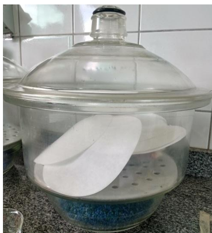
Figura 7. Teste de sólidos insolúveis em água na etapa dos papeis em filtro recém-saídos da estufa a 135°C realizado no Laboratório de Nutrição Animal do Instituto de Medicina Veterinária da UFPA em amostras de mel de abelha Melipona fasciculata e M. flavolineata .
