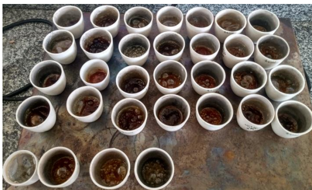
Figura 6. Teste de cinzas na etapa de carbonização das amostras realizado no Laboratório de Nutrição Animal do Instituto de Medicina Veterinária da UFPA em amostras de mel de abelha Melipona fasciculata e M. flavolineata .
