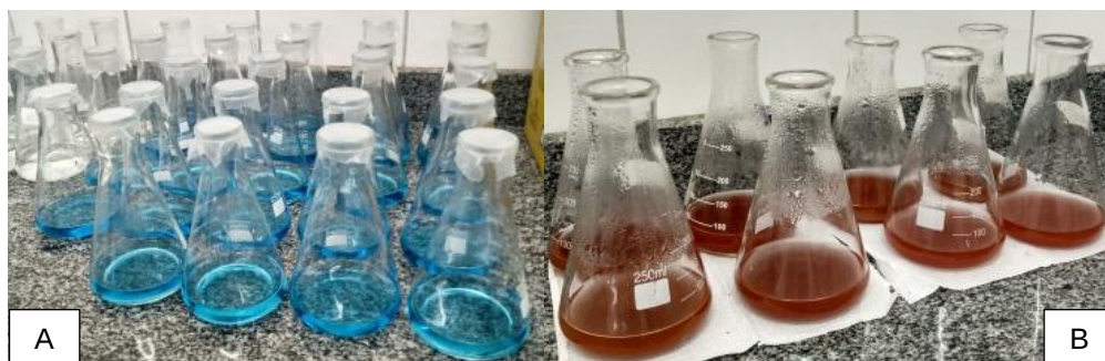
Figura 9. Teste de açúcares redutores realizado no Laboratório de Nutrição Animal do Instituto de Medicina Veterinária da UFPA em amostras de mel de abelha Melipona fasciculata e M. flavolineata . (A) Soluções de Fehling antes da titulação e aquecimento. (B) Soluções de Fehling após a titulação e aquecimento.
