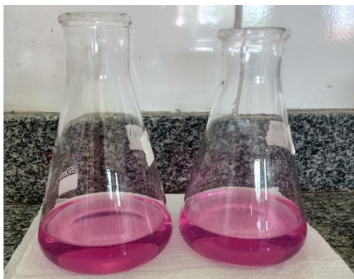
Figura 3. Teste de acidez realizado no Laboratório de Nutrição Animal do Instituto de Medicina Veterinária da UFPA em amostras de mel de abelha Melipona fasciculata e M. flavolineata . Fonte: Arquivo pessoal.
