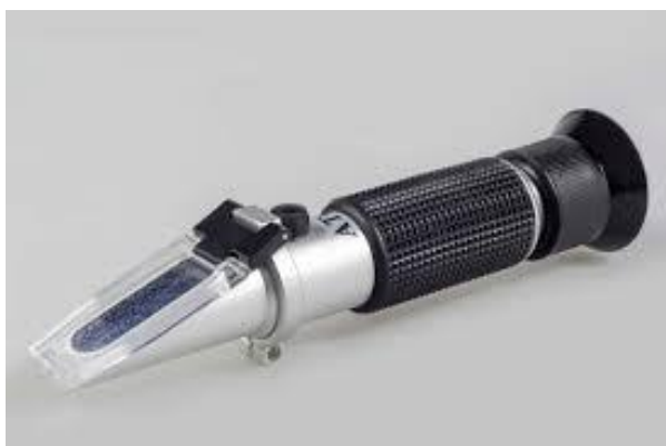
Figura 4. Refratômetro utilizado para o teste de grau Brix realizado no Laboratório de Nutrição Animal do Instituto de Medicina Veterinária da UFPA em amostras de mel de abelha Melipona fasciculata e M. flavolineata .
