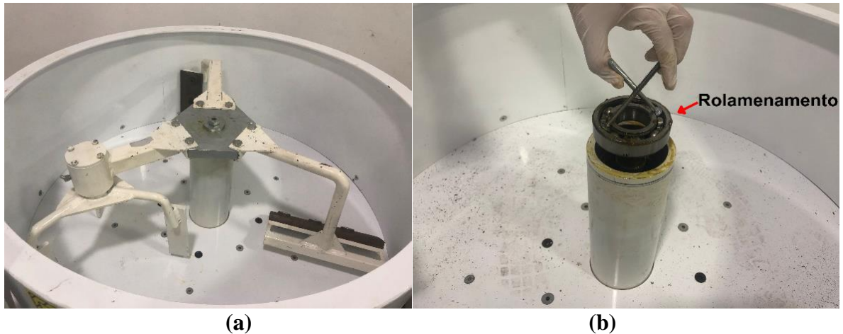
Figura 15. Localização do rolamento (a) Vista das disposições das pás de mistura (b) Extração do rolamento.
