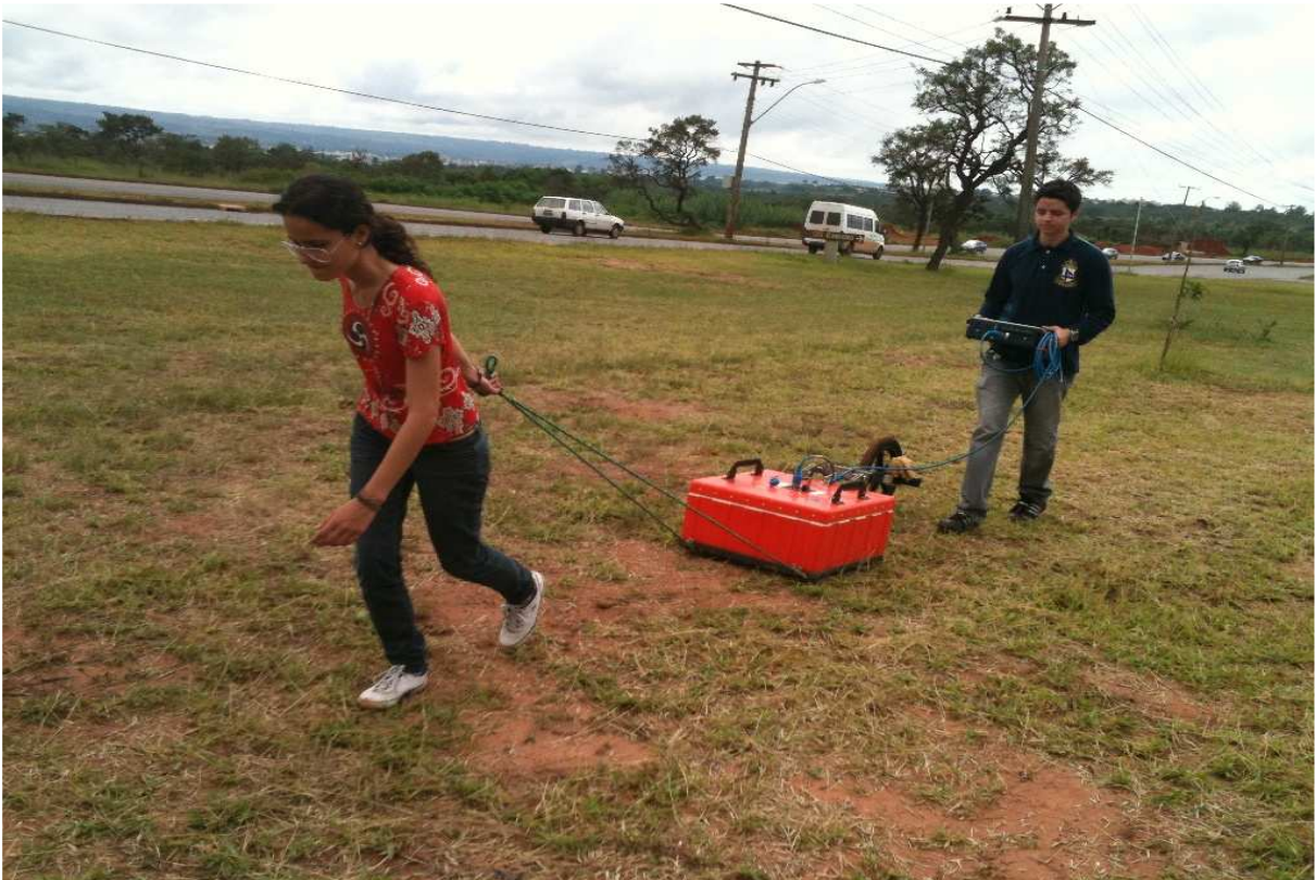
Figura 9.10 – Aquisição de dados próximo ao início do Perfil GPR C-D, no gramado lateral da DF-061 (EPAA) em direção ao alto topográfico formado pelo pacote de quartzito. (UTM SICAD 23L 188.329 E / 8.255.055 N).
