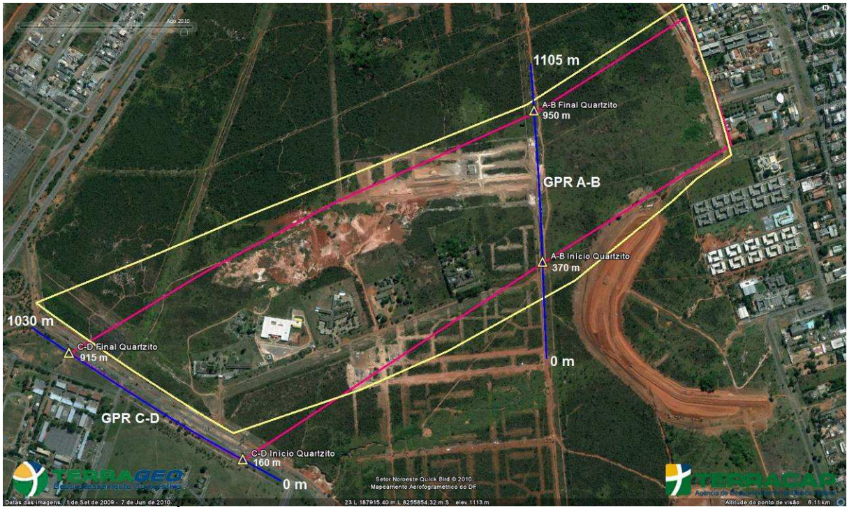
Figura 9.18 – Área de influência do pacote de quartzito (polígono rosa) traçado após interpretação dos dados do levantamento de GPR. Comparação com a poligonal traçada de forma aproximada a partir da presença de neossolos e blocos de quartzito (em amarelo).
