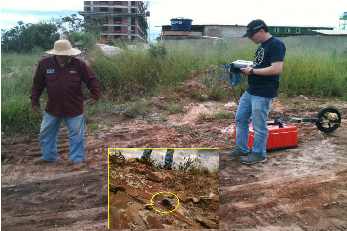
Figura 9.6 – Testes do equipamento em local com alvo conhecido (pacote de quartzito com atitude N80^{\circ}E35^{\circ}NW ). No detalhe o afloramento da rocha com mergulho mostrado pela bússola (círculo amarelo) (UTM SICAD 23L 188.062 E / 8.256.191 N).
