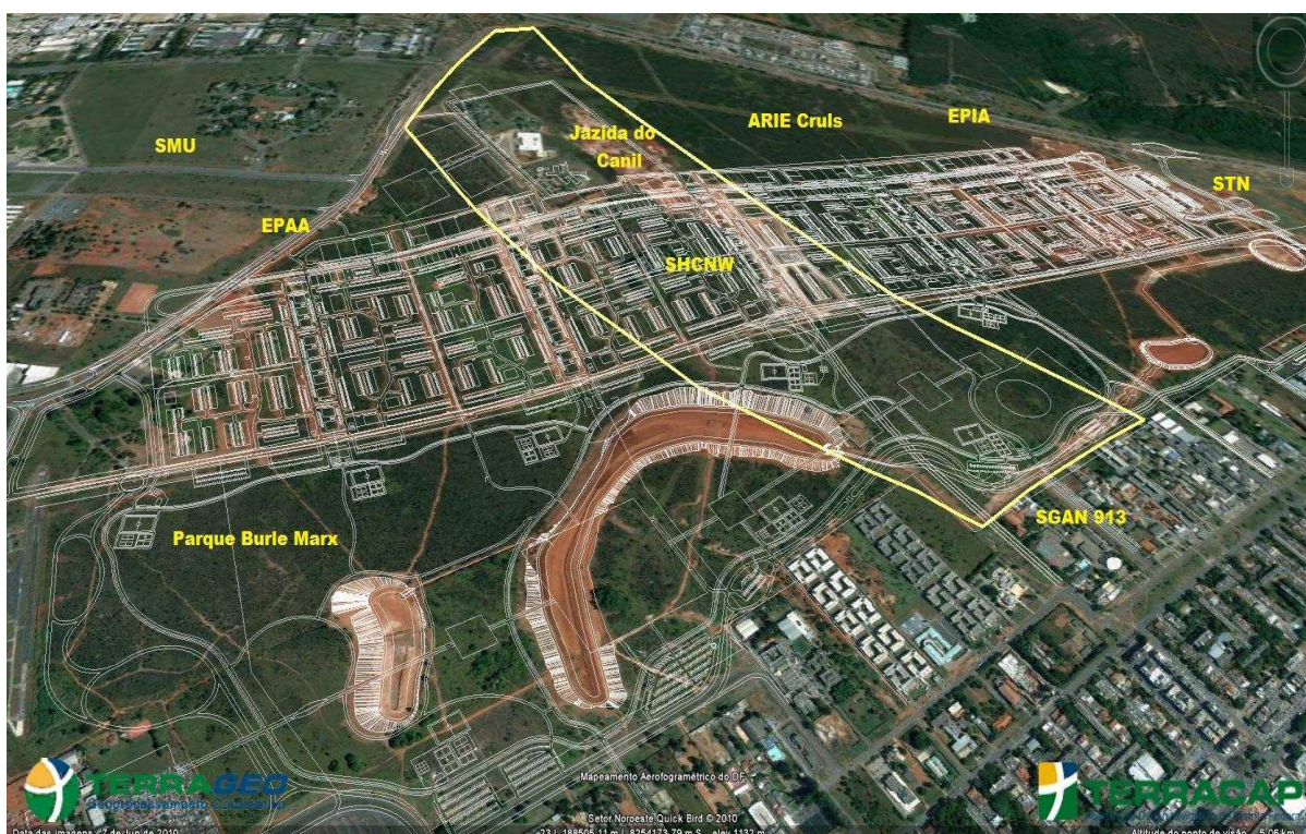
Figura 3.1 – Delimitação aproximada do pacote de quartzito na área de estudo, que coincide com uma elevação na topografia (polígono amarelo). Notar sua interferência com o SHCNW e demais logradouros públicos.
