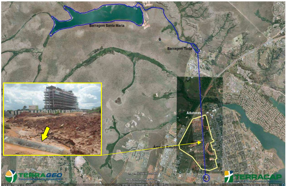
Figura 8.1 – O sistema de abastecimento Santa Maria/Torto e a interferência das adutoras na área de estudo. No detalhe, parte de uma das adutoras exposta por processos erosivos próximos à futura quadra SQNW 107 (UTM SICAD 23 L 188.352 E / 8.256.334 N).
