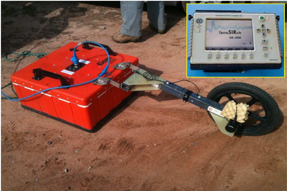
Figura 9.2 – Aspecto do equipamento utilizado: antena blindada de 200 Mhz, roda odométrica e cabos. No detalhe a unidade de controle portátil (GPR SIR-3000 GSSI).
