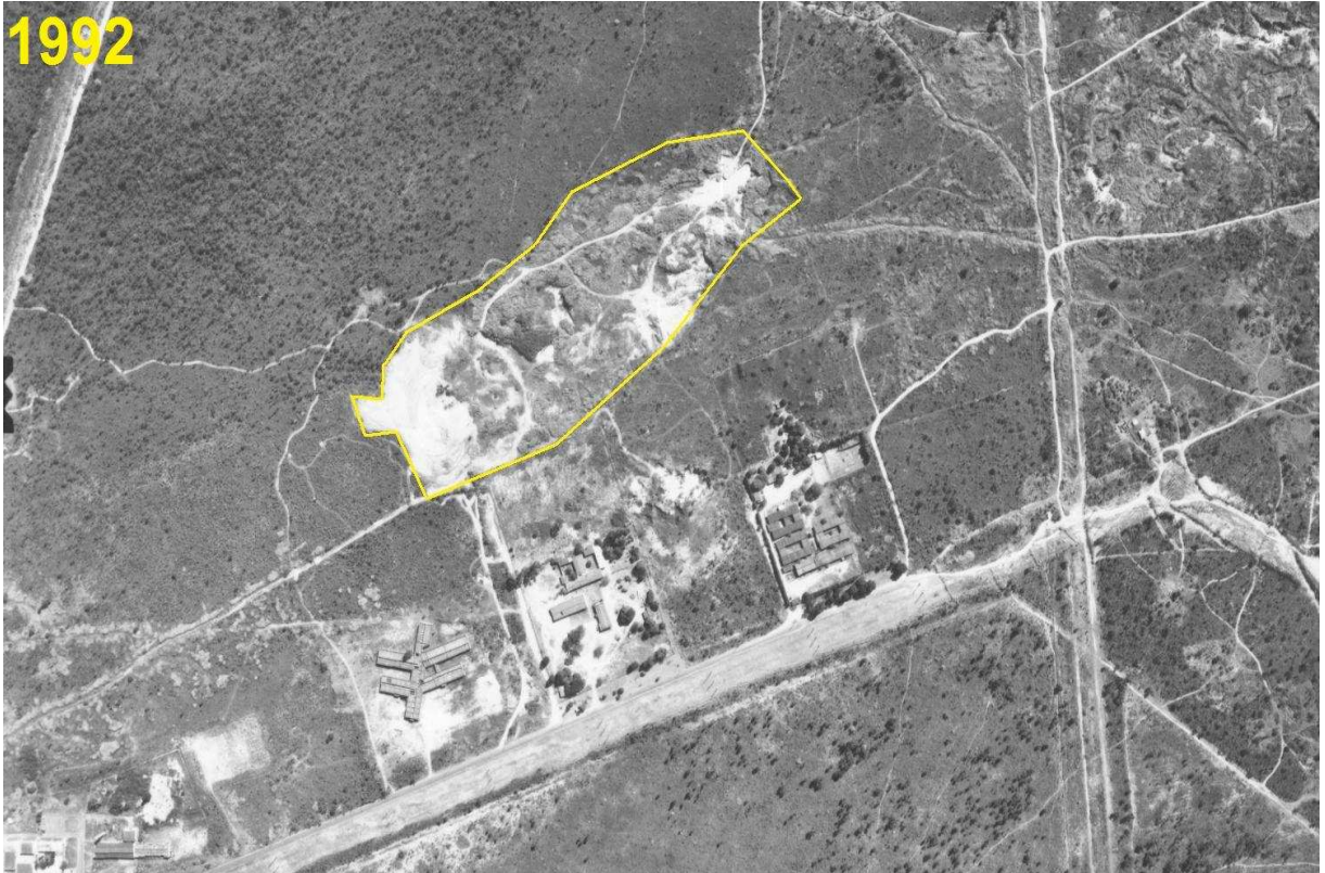
Figura 7.7 – Aerofotografia de 1992 (escala: 1: 9.000) mostrando a delimitação da lavra de areia na Jazida do Canil (poligonal em amarelo).
