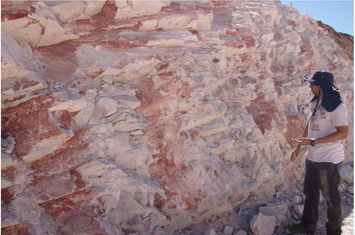
Figura 6.4 – Escavação predial mostrando camadas de quartzito (atitude média: N85°E/ 35° NW) cujos planos de acamamento e fratura apresentam filmes de óxido de ferro de cor vermelha. (UTM SICAD 23L 188.212 E / 8.256.231 N)
