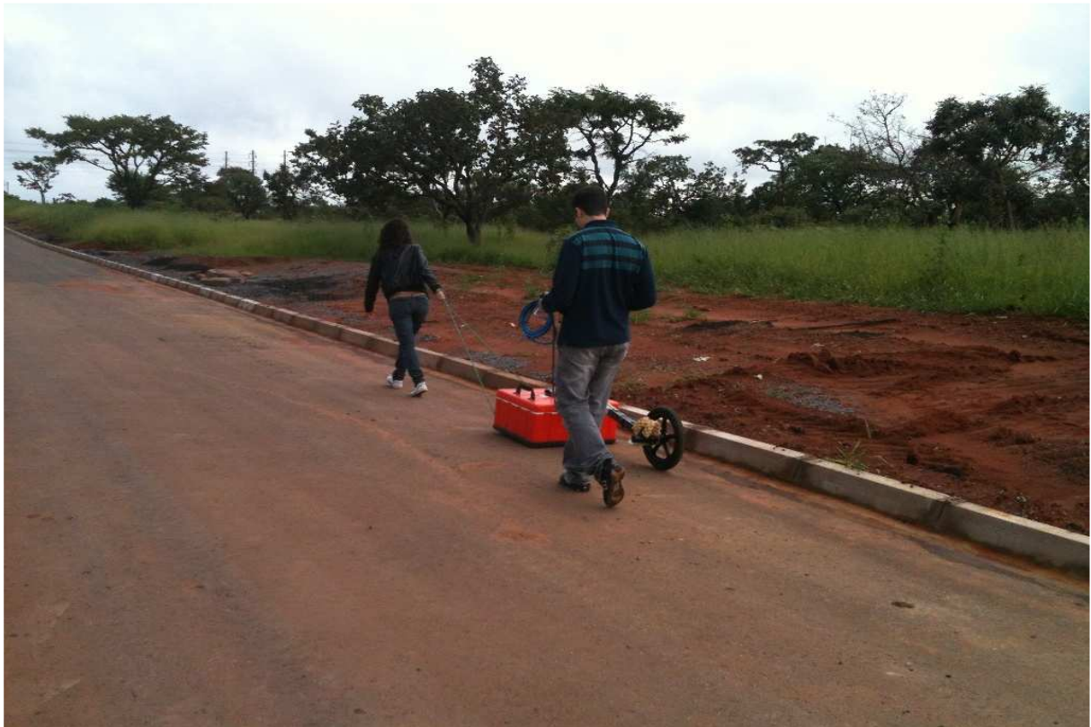
Figura 9.8 – Aquisição de dados próximo ao início do Perfil GPR A-B, ao longo da via W-7, em direção ao alto topográfico formado pelo pacote de quartzito. (UTM SICAD 23L 188.386 E / 8.255.585 N).
