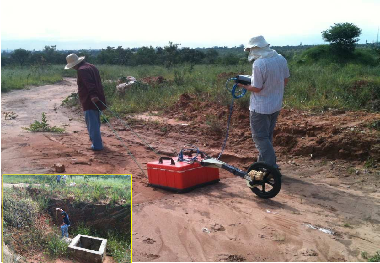
Figura 9.4 – Testes do equipamento em local com alvo conhecido (tubulação de concreto a 1,5 metro de profundidade). No detalhe a tubulação exposta a poucos metros do local do levantamento. (UTM SICAD 23L 187.763 E / 8.255.442 N).
