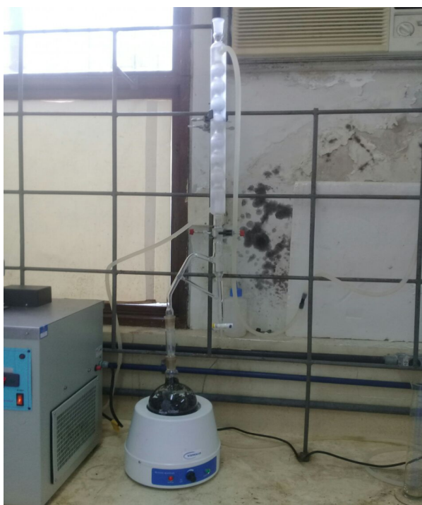
Figura 2 – hidrodestilação tipo clewenger, adaptações do LEPRON – UFPA
