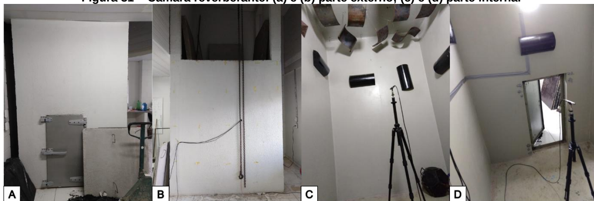
Figura 31 – Câmara reverberante: (a) e (b) parte externo; (c) e (d) parte interna.
