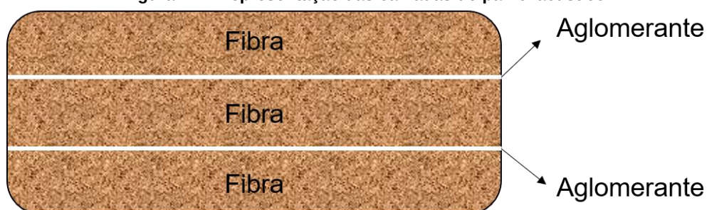
Figura 22 – Representação das camadas do painel acústico.
