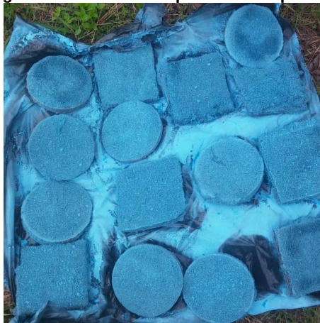
Figura 25 – Painéis em processo de pintura.
