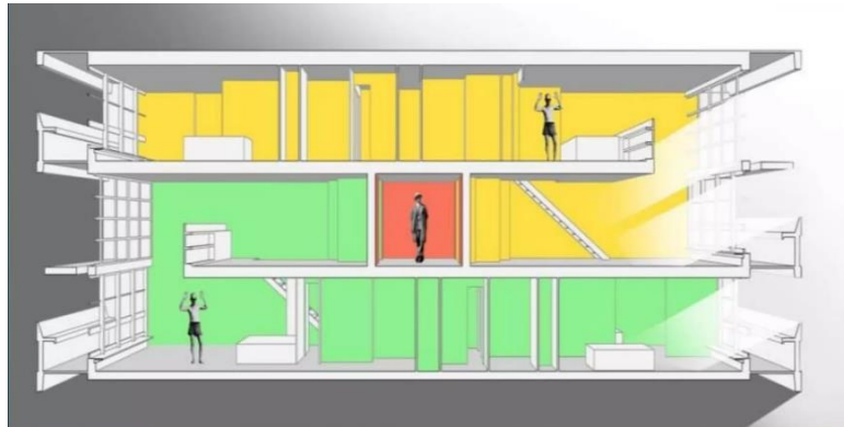
Figura 10 – Corte esquemático dos apartamentos da Unidade de Habitação de Marselha. Fonte: slideshare.net
