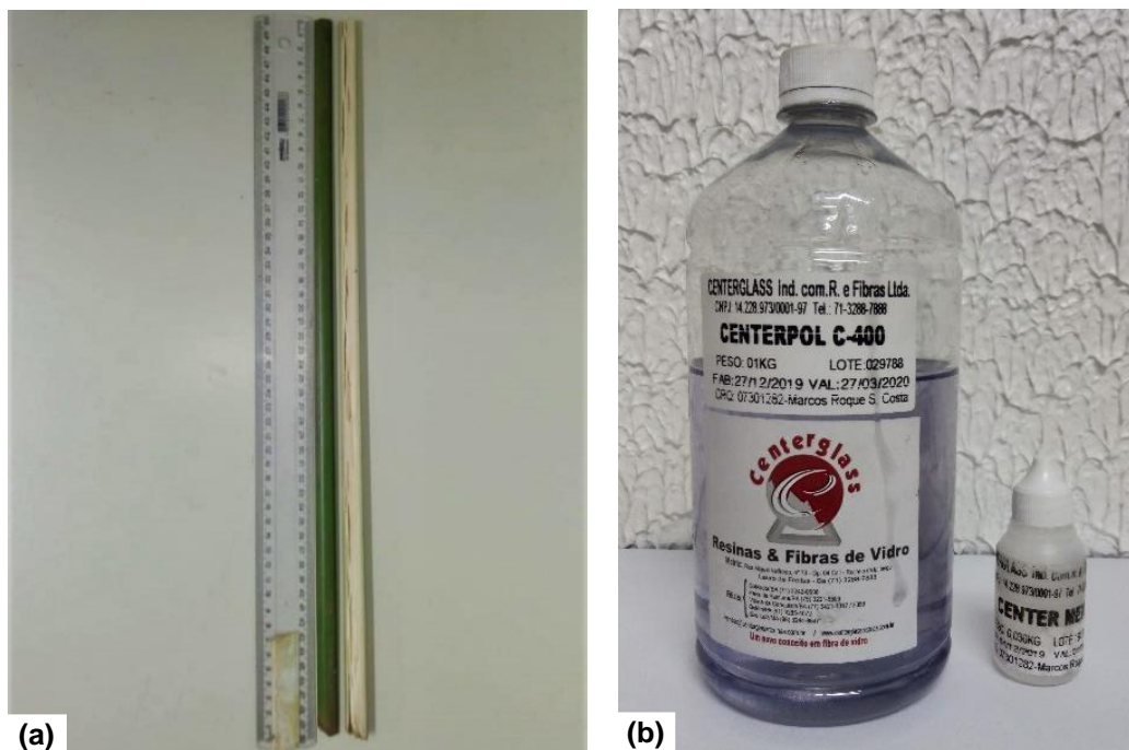
Figura 4 – (a) haste caulinar do Guarumã; (b) resina e catalizador utilizados neste trabalho
