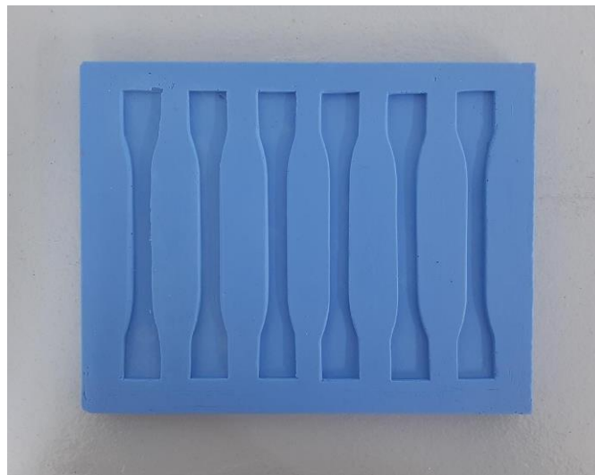
Figura 9 – Molde de silicone utilizado na fabricação dos corpos de prova
