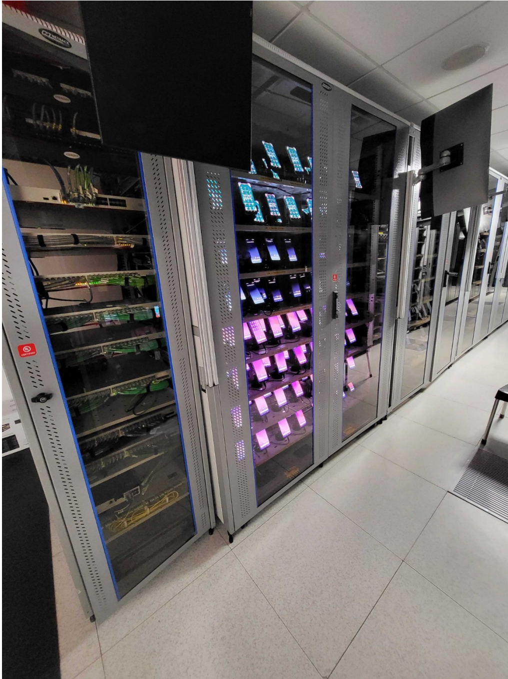
Figura 9 - Pixel device farm privado da BigTech Uber , todos esses dispositivos podem ser acessados remotamente para testes e demais etapas de desenvolvimento pela equipe.
