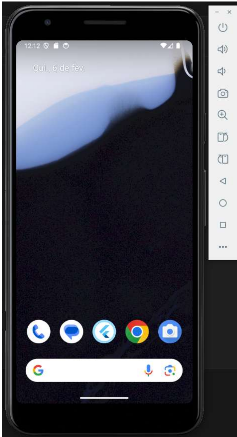
Figura 5 - Emulador AVD em execução simulando um smartphone Pixel 3A API level 34 (referente ao Android 14) executado em dispositivo Linux
