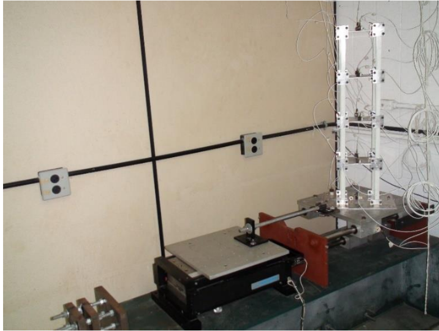
Figura 18 - Sistema experimental realizado, com um pórtico posicionado a 45° em relação ao eixo de excitação
