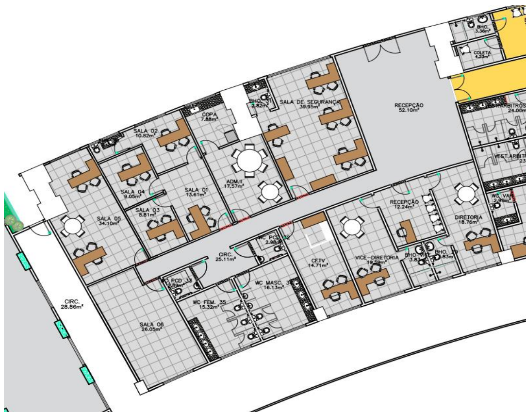
Fig. 40 - Ala administrativa do estádio. Fonte: Cedido pelo consórcio de obras mangueirão.
