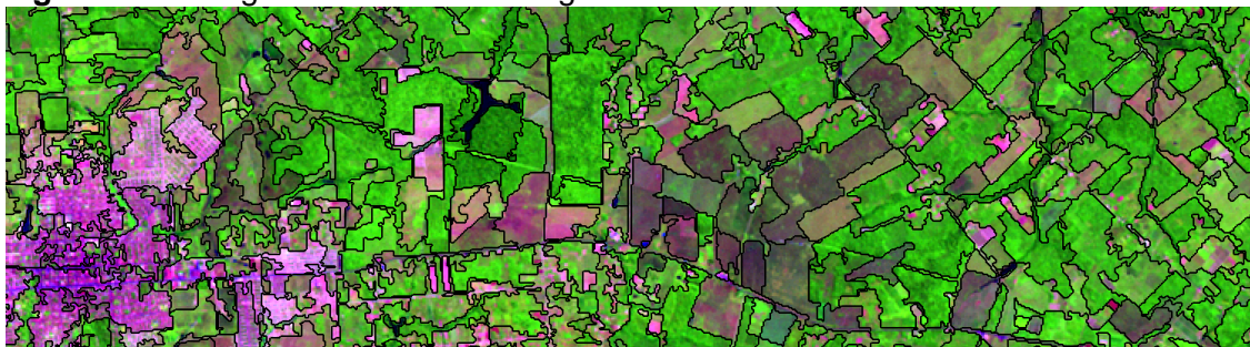
Figura 2.2 - Imagem Landsat-5/TM segmentada com limiar de similaridade = 100.
