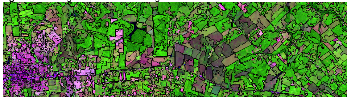
Figura 2.3 - Imagem Landsat-5/TM segmentada com limiar de similaridade = 50.
