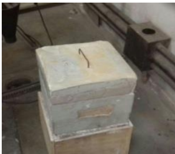
Figura 15 – Forno após a retirada do molde de compensado
