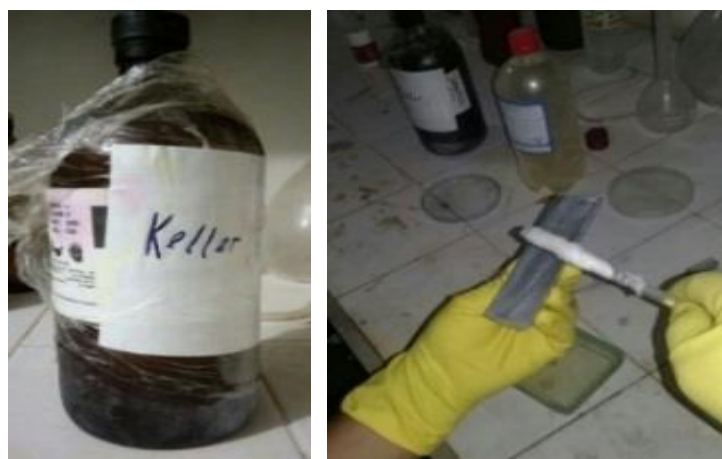
Figura 27 - (a) Keller - solução aquosa ácida e (b) Keller sendo passado na liga de alumínio +2,5% de níquel
