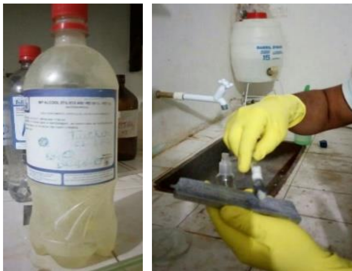
Figura 28 - (a) Tucker - solução aquosa ácida e (b) Tucker sendo passado na liga de alumínio + 9% de níquel
