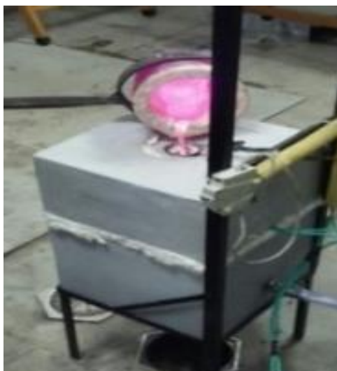
Figura 25 - Vazamento do metal dentro da lingoteira
