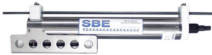
Figura 10- Imagem ilustrativa do equipamento CTD utilizado para análise verticais do campo de massa (TS) da PCA.
