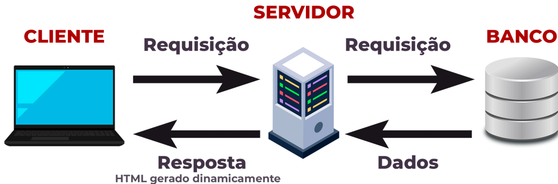
Figura 36 - Server-Side Rendering na prática. Desde a requisição do cliente até a resposta preparada do servidor.
