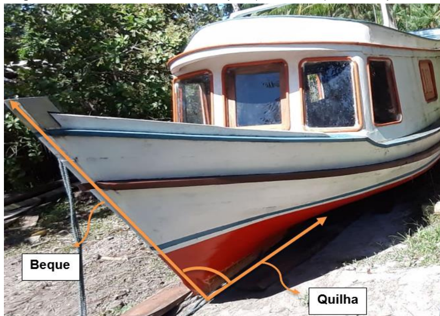
Figura 13- ângulo formado da união do beque (talha-mar) com a quilha do barco.
