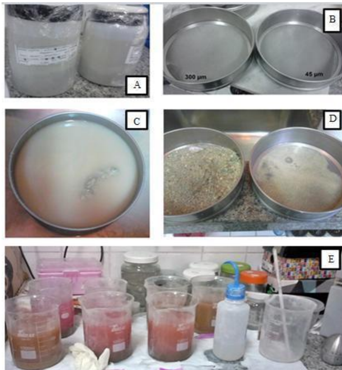
Figura 3- Potes contendo amostras biosedimentológicas (A), Peneiras de 300 \mu\text{m} e 45 \mu\text{m} (B), Peneira de 300 \mu\text{m} contendo amostra biosedimentológica, pré-peneiramento com água corrente (C), Peneiras de 300 \mu\text{m} e 45 \mu\text{m} , pós -peneiramento com água corrente (D), Processo de flotação (E).
