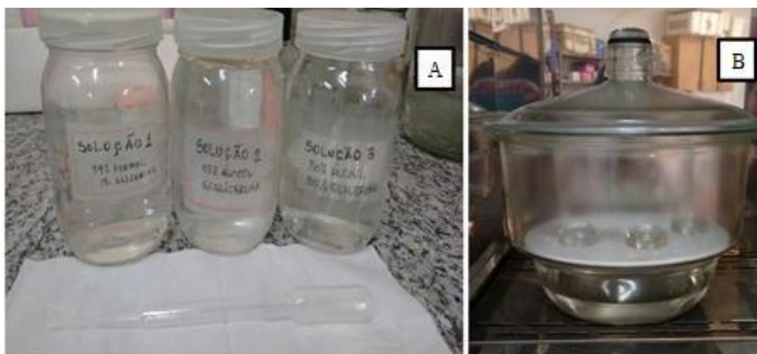
Figura 5- Soluções utilizadas no processo de diafanização (A) e amostras em repouso em no dessecador dentro da estufa (B).
