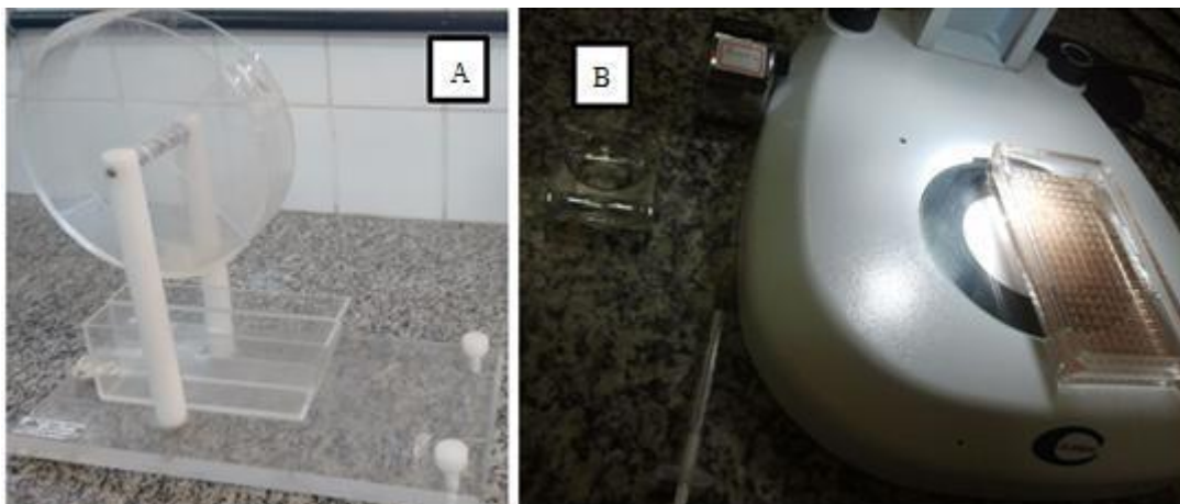
Figura 4- Quarteador de Folsom (A) e equipamentos utilizados para triagem da nematofauna (B).
