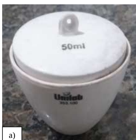
Fotografia 6 - a) Cadinho tampado; b) CACB3H dentro do cadinho.
