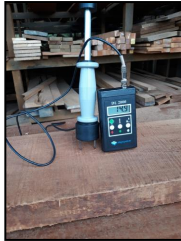
Figura 8 – Medição de umidade da madeira.
