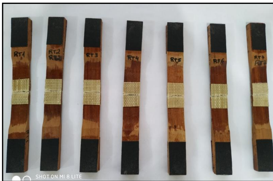
Figura 29 – Ruptura dos CPs - RT.
