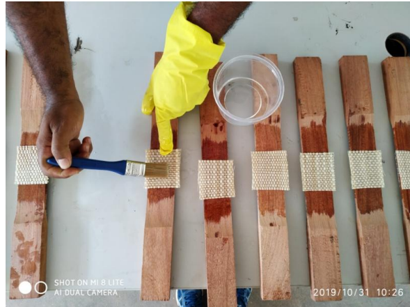
Figura 17 – Laminação do compósito.
