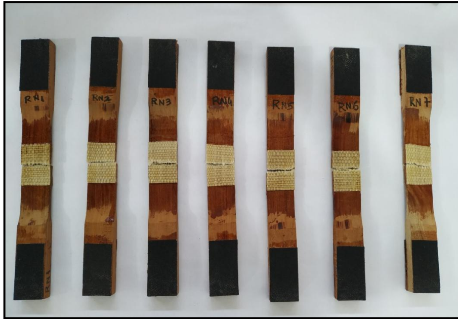
Figura 28 – Ruptura dos CPs - RN.
