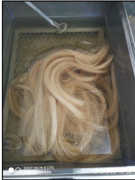
Figura 11 – Tratamento térmico nas fibras de sisal.
