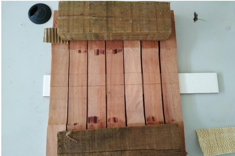
Figura 16 – Corte da região a ser reforçada.
