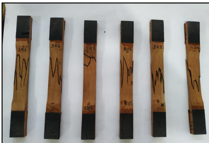
Figura 27 – Ruptura dos CPs - SR.
