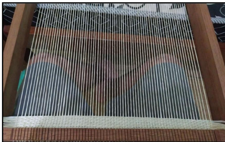
Figura 13 – Processo de tecelagem do tecido de sisal.
