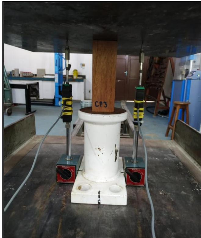
Figura 23 – Ensaio de compressão paralela às fibras.
