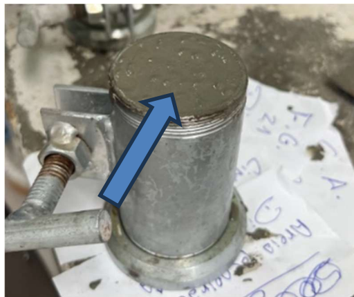
Figura 5 – Molde com concreto fresco não exsudado/segregado do traço com 10% de EPS (Autor, 2025).
