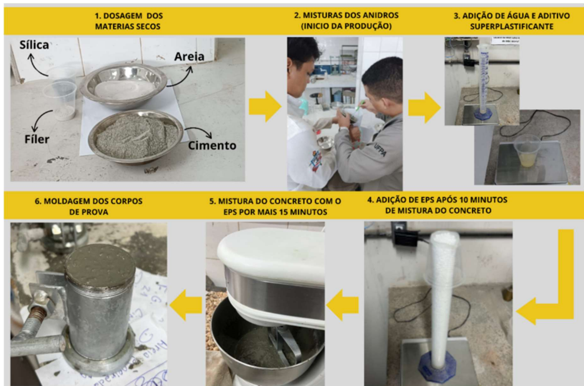
Figura 2 - Detalhamento do processo de mistura e produção do CLAR (Autor, 2025).
