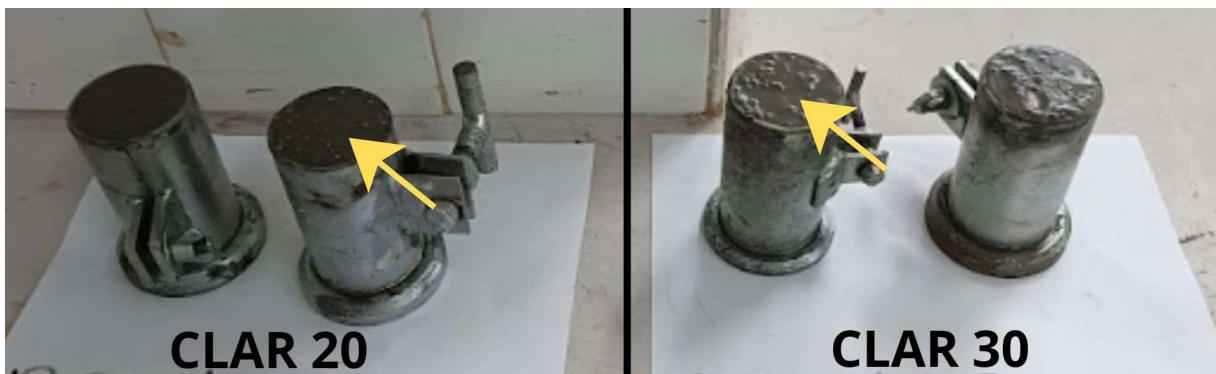
Figura 6 – Molde com concreto fresco não exsudado/segregado do traço com 20% e 30% de EPS (Autor, 2025).
