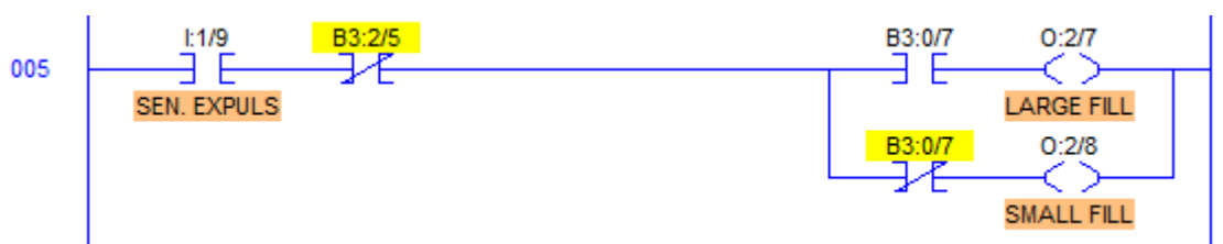
Figura 93 - Sistema de controle de enchimento conforme o tamanho das garrafas.
