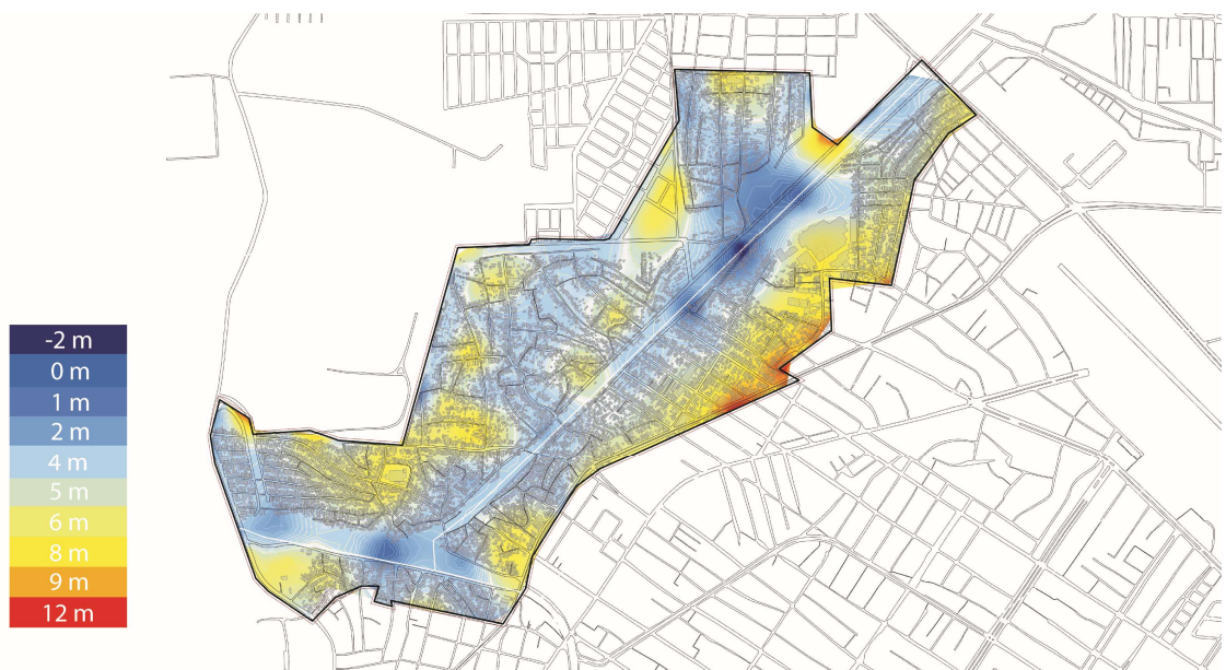
Figura 4 - Análise do caimento das águas pluviais
