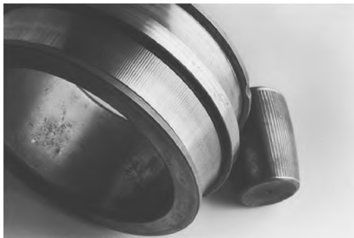
Figura 15 – Falha em rolamento causada por passagem de corrente elétrica.
