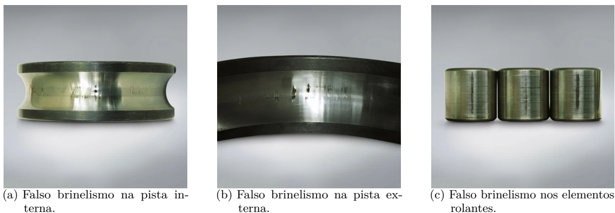
Figura 14 – Exemplos de falso brinelismo em diferentes componentes de rolamentos.
