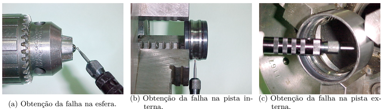
Figura 13 – Obtenção de falhas induzidas com uma microrretífica.
