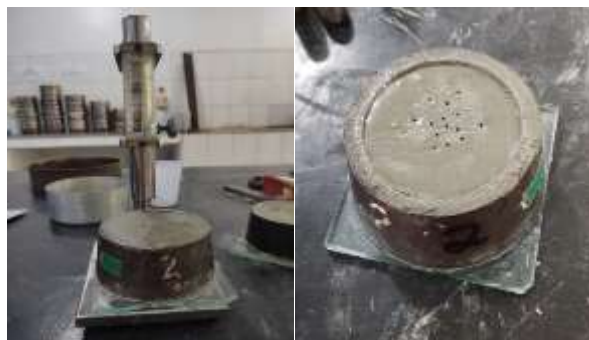
Figura 04- Aparelho Vicat para o ensaio de tempo de início de pega e aspecto do corpo de prova após finalização do ensaio.
