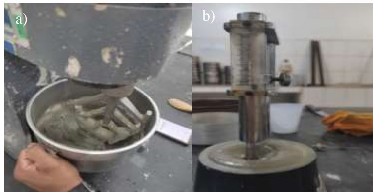
Figura 03 - a) Misturador Mecânico, b) Leitura com a sonda Tetmajer.
