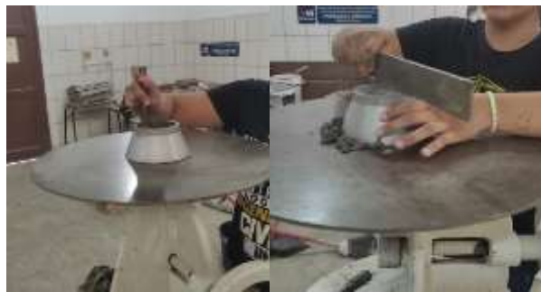
Figura 05- Sequência de procedimentos do ensaio de índice de consistência.
