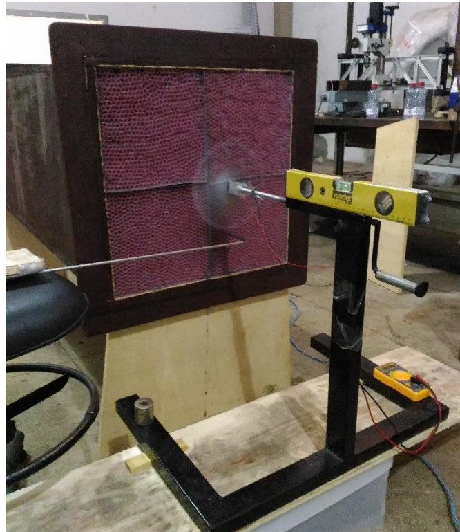
Figura 41 - Microgerador posicionada para medição da tensão elétrica.
