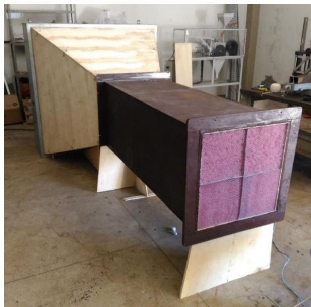
Figura 37 - Túnel de vento finalizado.
