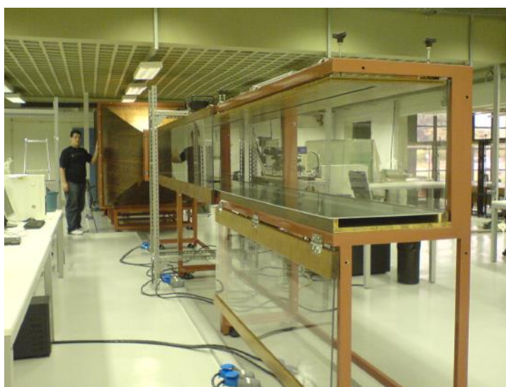
Figura 9 - Túnel de vento com destaque a seção de testes de com lateral abaixada.
