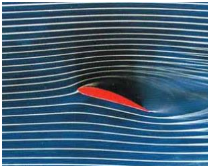
Figura 21 - Visualização do escoamento pela utilização de fumaça em um túnel de vento.
