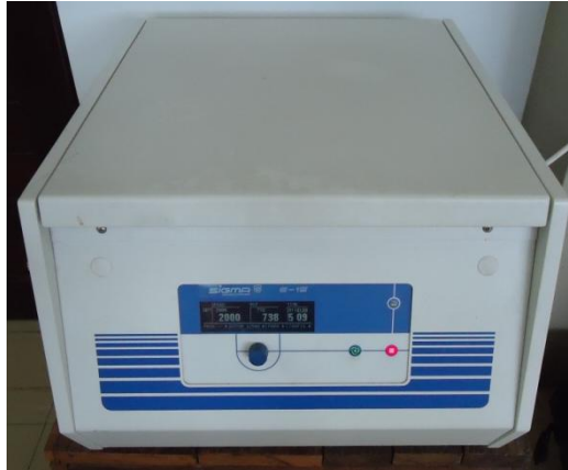
Figura 12- Centrífuga utilizada para a separação do sobrenadante referente à solução de peróxido de hidrogênio ( H_2O_2 ).
