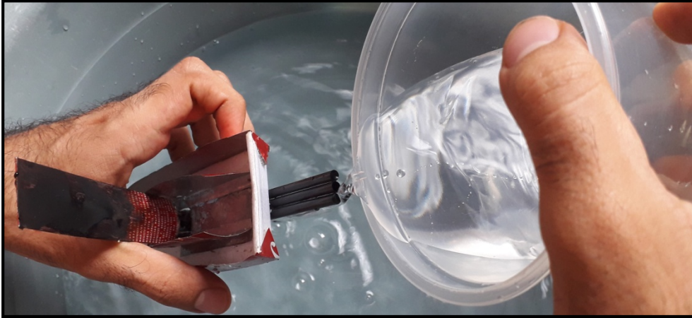
Fotografia 3: Procedimento Para Preencher de Água a “Caldeira” do Barco
