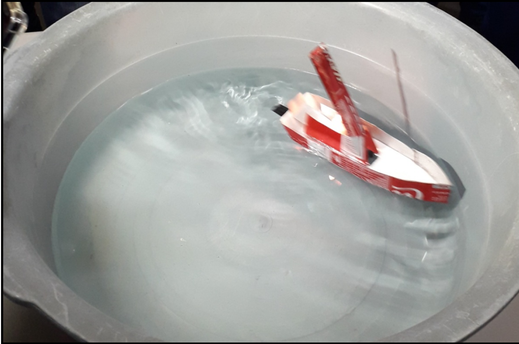
Fotografia 4: O Barco se Movendo Sob a Ação do Vapor na Caldeira e no Propulsor de Canudinho
