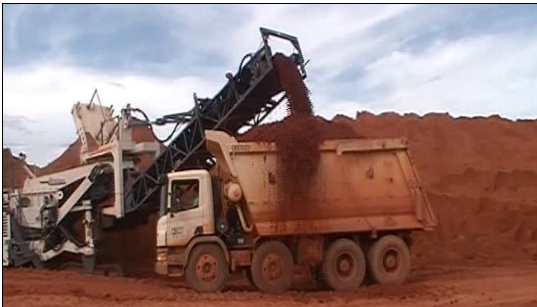
Figura 17 – Carregamento a 45° com derramamento de material
