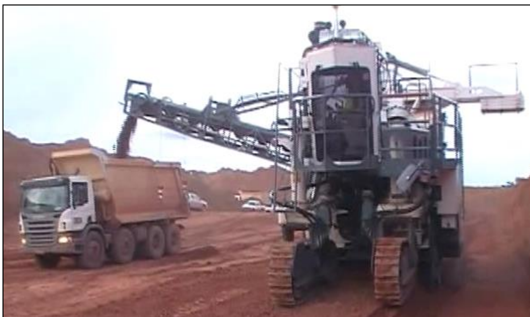
Figura 18 – Carregamento a 90° sem derramamento de material
