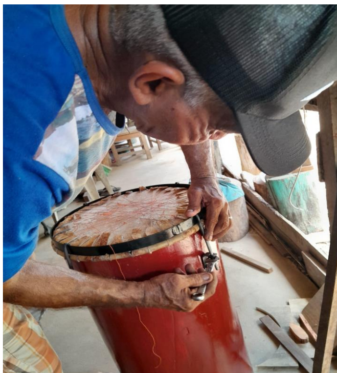
Figura 16 – Etapa de esticamento e fixação do couro no curimbó
