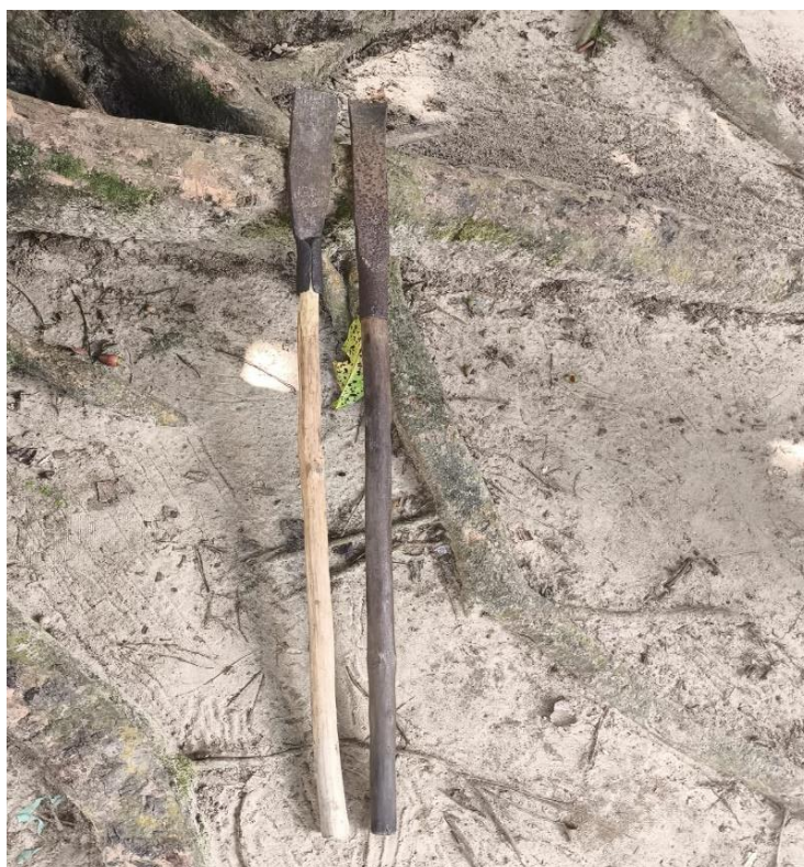
Figura 10 – Ferramentas tradicionais utilizadas para escavar o curimbó (cunhas e talhadeiras)
