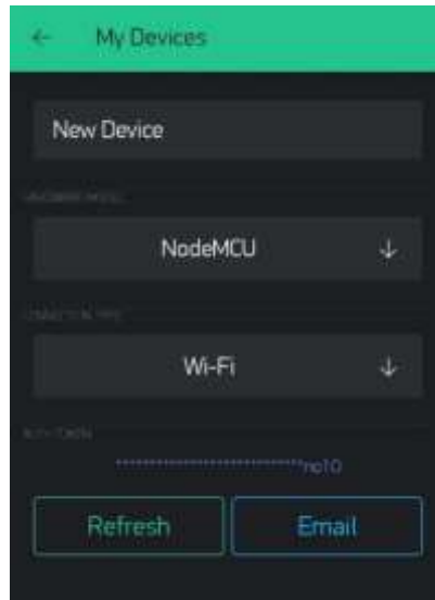
Figura 20: Interface do Blynk com o tipo de placa e conexão selecionado. Fonte: autor
