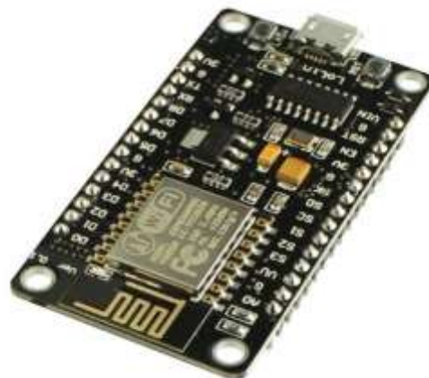
Figura 8: Nodemcu V3 Esp8266. Fonte: [26]
