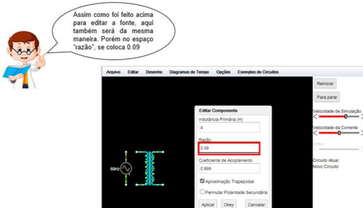
Figura – 44. Editando o transformador 5
