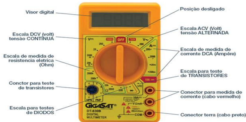
Figura – 27. Como usar um multímetro.
