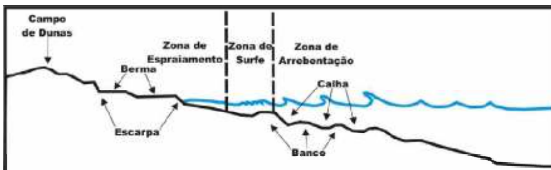
Figura 13 – Classificação das principais zonas do perfil praiado sob o ponto de vista hidrodinâmico (Extraído de Alves, 2002).
