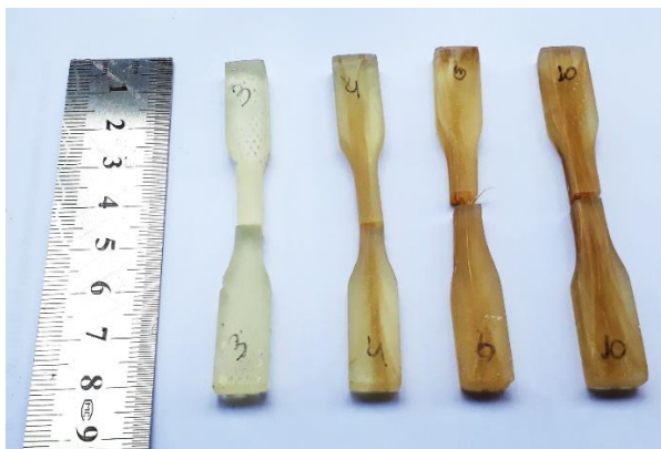
Figura 22 – Aspecto macroscópico da fratura dos compósitos ensaiados em tração.
