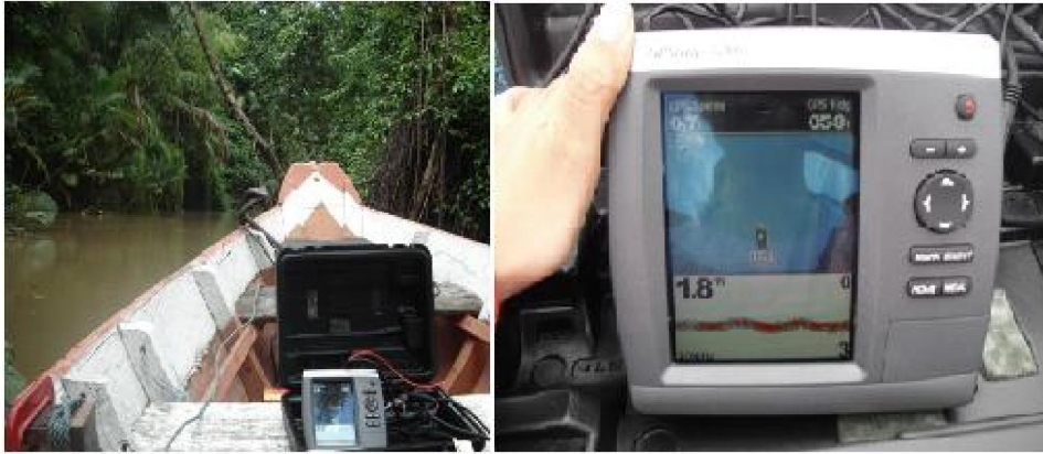
Figura 9 – Ecobatímetro utilizado para a obtenção das profundidades nos canais de maré estudados.
