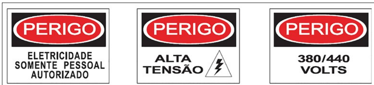
Figura 8: Placas de sinalização de risco elétrico
