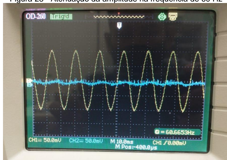
Figura 28 - Atenuação da amplitude na frequência de 60 Hz
