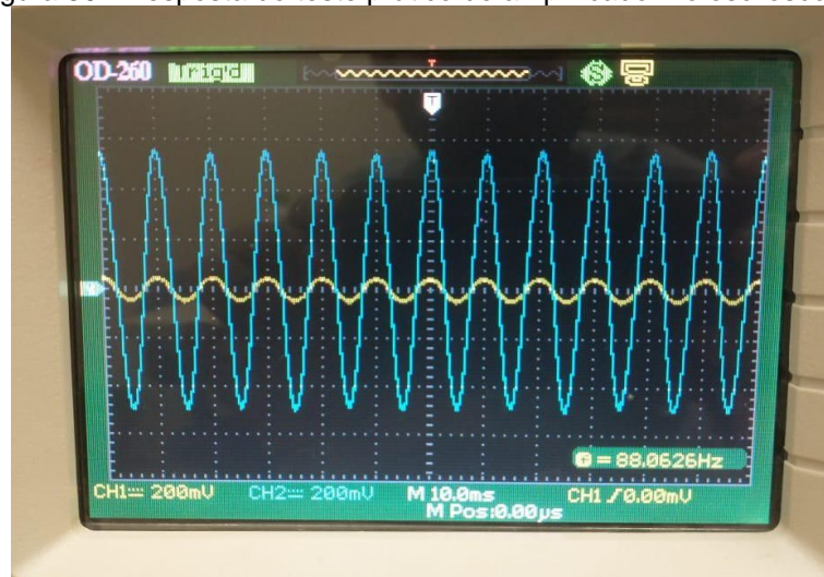
Figura 30 - Resposta do teste prático do amplificador no osciloscópio
