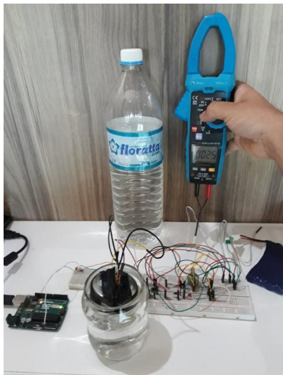
Figura 42 - Teste do sensor de CE na água Floratta.
