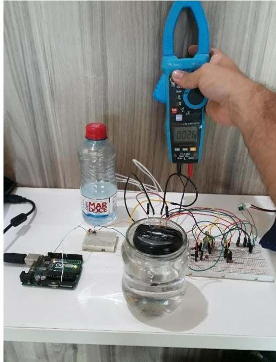
Figura 45 - Teste do sensor de CE na água Mar Doce.
