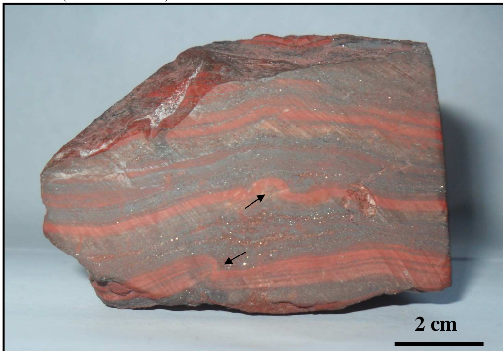
Figura 19 - Foto dos contatos interpenetrativos de banda de opacos na banda de jaspe (setas) (Amostra TJ-7-E-A).
