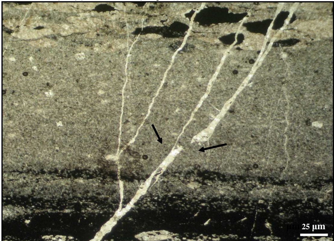
Figura 28 - Fotomicrografia mostrando o deslocamento horizontal na banda silicosa, evidenciado pela falha (setas) (Amostra VW-6-A). Obj. 5X, nicóis //.
