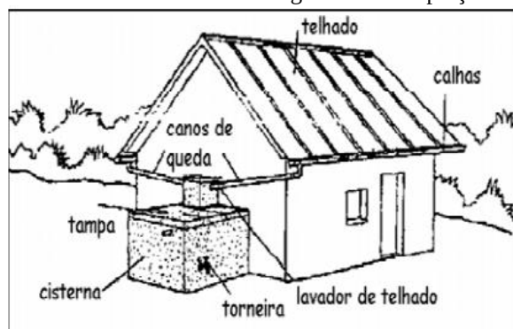
Figura 26 Estrutura básica de um sistema genérico de captação de água de chuva.
