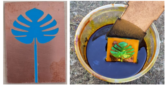
Fig. 3. Fabricação da antena bioinspirada: (a) Mascara de vinil adesivo após o corte a laser; (b) Processo de corrosão por percloroeto de ferro.
