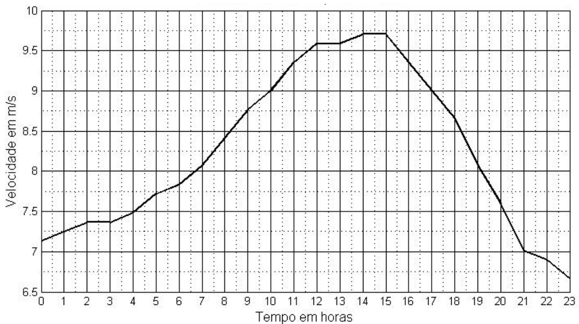
Figura 34 – Curva de vento ajustada para 70 m.
