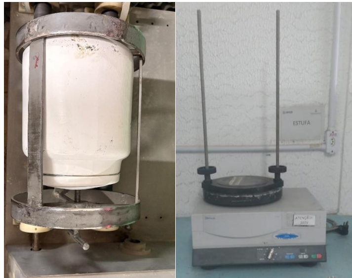
Figura 9 – Beneficiamento do resíduo: (a) Moinho de jarro da moagem; (b) Agitador mecânico
