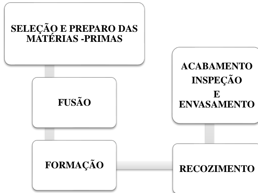
Figura 8 — Fluxograma das etapas de produção do vidro.
